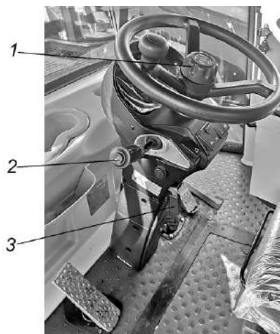
1 - гайка-барашек регулировки рулевого колеса по высоте; 2 - подрулевой переключатель; 3 - рукоятка фиксации угла наклона рулевой колонки
